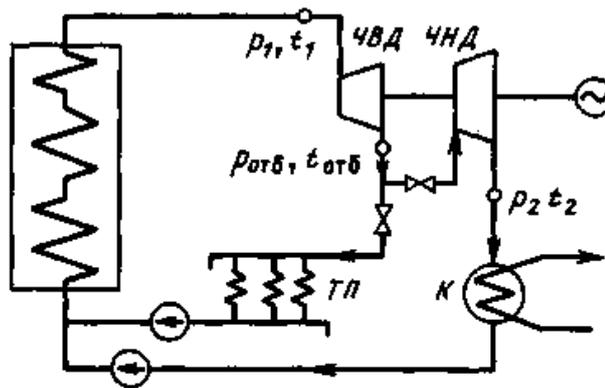
Рисунок 9.3. Установка турбины с регулируемым отбором пара
