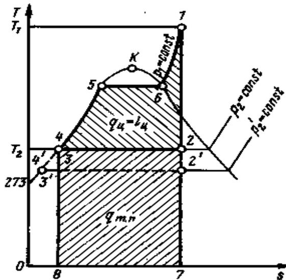
Рисунок 9.2. Теплофикационный цикл в  $T, s$  – диаграмме
