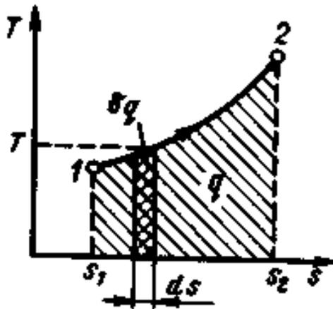
Рисунок 3.1. Графическое изображение теплоты в  $T, s$  – координатах
