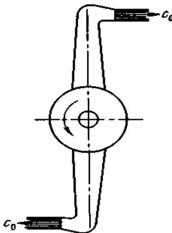
Рисунок 8.4. Схема первой модели реактивной паровой турбины
