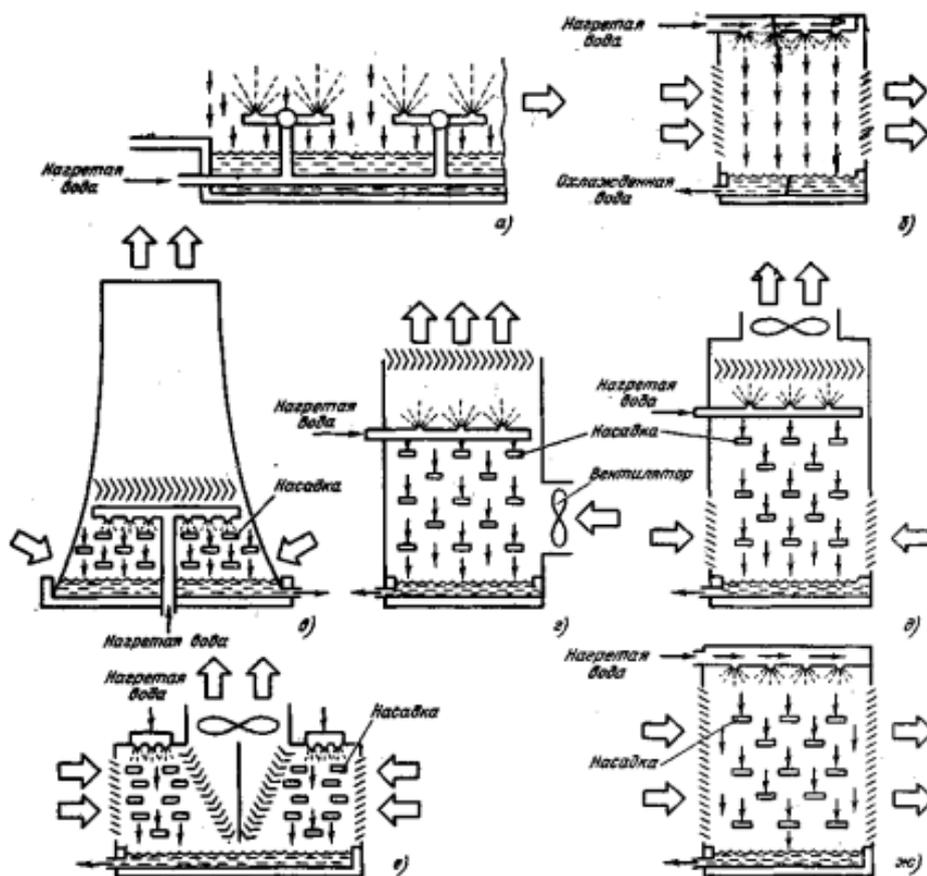
Рисунок 9.6 - Охлаждающие устройства различных типов: а – брызгальный бассейн; б – открытая брызгальная градирня; в – испарительная градирня с гиперболической башней; г - градирня с принудительной циркуляцией воздуха; д – градирня со всасывающим вентилятором и противоточным движением воздуха; е - градирня со всасывающим вентилятором и поперечным движением воздуха; ж – открытая градирня с оросительным устройством
