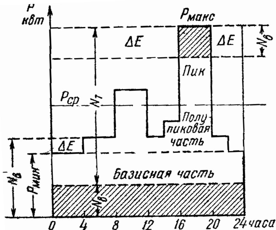
Рисунок 12.3. Возможные варианты работы ГЭС без суточного регулирования в покрытии нагрузки энергосистемы
