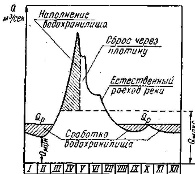
Рисунок 11.7. Сезонное регулирование стока
