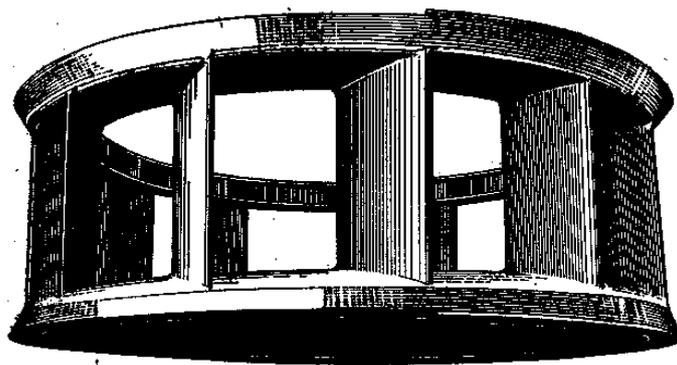
Рисунок 10. 6. Общий вид статора реактивной турбины
