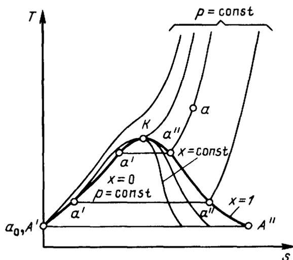
Рисунок 3.5.  $T, s$  - диаграмма водяного пара
