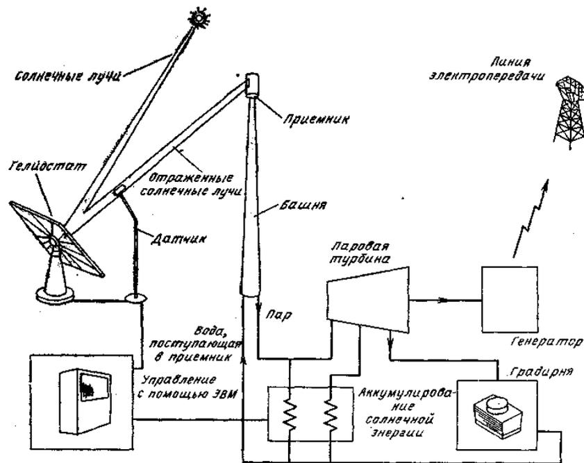
Рисунок 13.2. Принцип работы солнечной электростанции башенного типа
