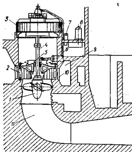
Рисунок 10. 5. Схема устройства поворотно-лопастной гидротурбины
