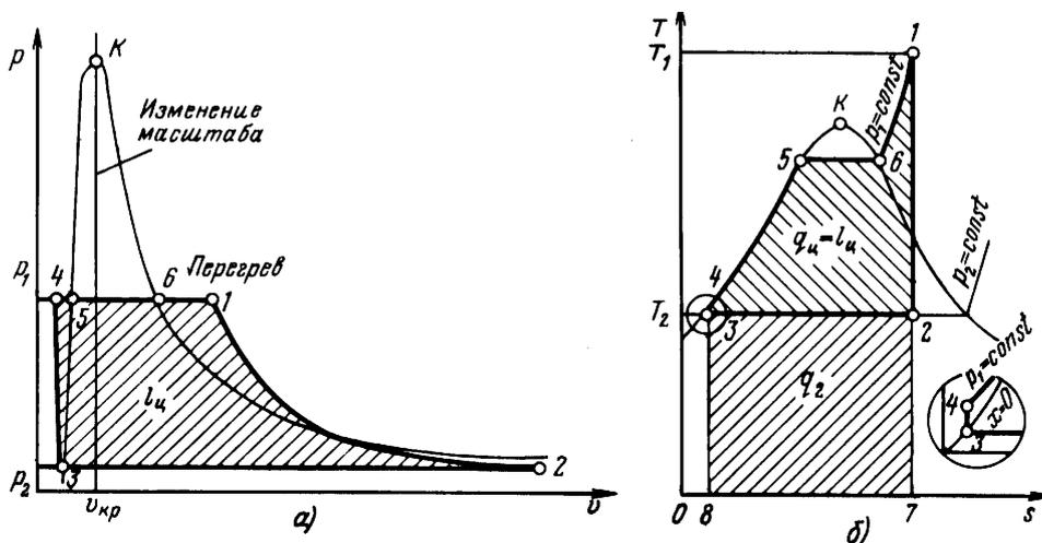
Рисунок 4.3. Цикл Ренкина на перегретом паре:
