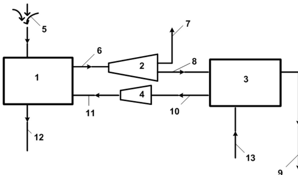
Рисунок 15.4 - Схема работы: 1 – котел испаритель; 2 – турбогенератор; 3 – конденсатор; 4 – компрессор; 5 – теплая вода (25°C); 6 – пары аммиака (20°C) под высоким давлением; 7 – вырабатываемая электроэнергия; 8 – пары аммиака (10°C) под низким давлением; 9 – сбрасываемая холодная вода (7°C); 10 – жидкий аммиак (10°C) под низким давлением; 11 – жидкий аммиак (10°C) под высоким давлением; 12 – сбрасываемая теплая вода (23°C); 13 – забор холодной воды (5°C)
