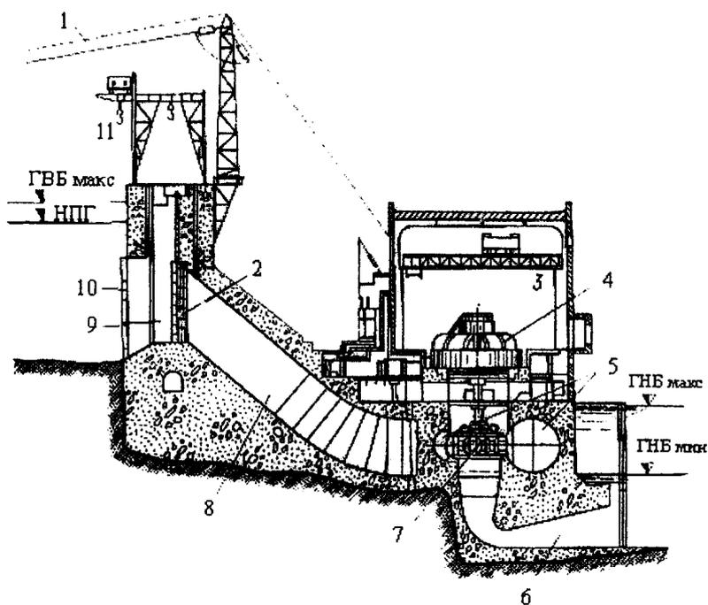
Рисунок 10.2 - Поперечный разрез приплотинной гидроэлектростанции:
