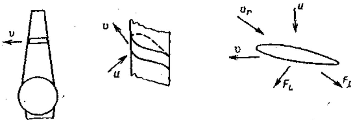
Рисунок 14.2. Скорости элемента лопасти и действующие на него силы:  $u$  - скорость ветра;  $v$  - скорость элемента лопасти;  $v_r$  - скорость элемента лопасти относительно скорости ветра;  $F_D$  - сила лобового сопротивления, действующая в направлении скорости  $v_r$ ;  $F_L$  - подъемная сила, перпендикулярная силе  $F_D$
