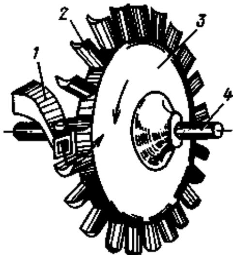
Рисунок 8.2. Схема ступени турбины
