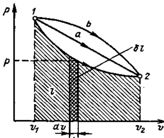
Рисунок 2.2. Графическое изображение работы в  $p, v$ -координатах
